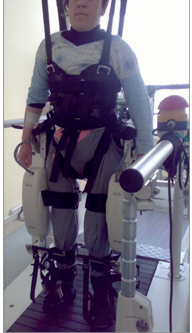
Şekil 1: Robotik yürüme cihazında bacak kaflarının bağlanma yerleri.
